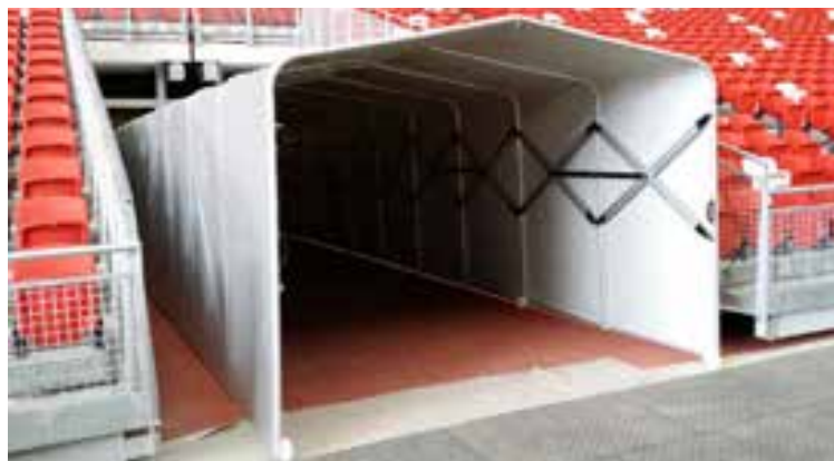
S12692 - Tunnel de foot rétractable. Cadre en aluminium anodisé. Toit et cotés en PVC ignifugé M2. Roues en polyamide. Taille : sur mesure. Longueur : jusqu'à 14.7m. Largeur : 1.5m à 3m. Hauteur : standard - 2.3m.
