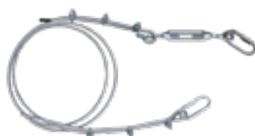
S14745 - Kit de rénovation pour 2 baskets charpente. Composé de : Câble Ø6mm, cosses cœur, maillons rapide, serre-câble, tendeurs avec contre écrou.
