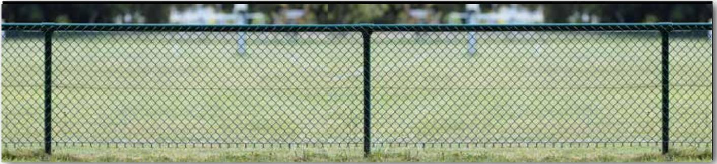
Les rouleaux de grillage main courante font 25ml. Ils sont en fil galvanisé gainé plastifié vert simple torsion. Maille 50x50mm. Ils sont livrés avec leurs accessoires de pose (fils de tension, fils d'attache, raidisseurs et barres de tension).
