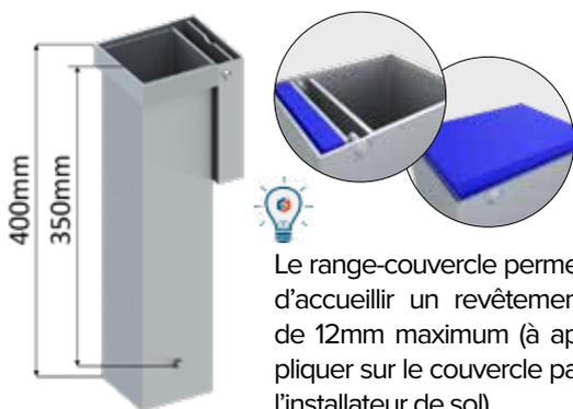
Le range-couvercle permet d'accueillir un revêtement de 12mm maximum (à appliquer sur le couvercle par l'installateur de sol).
