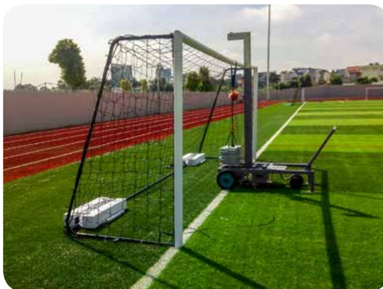
Afin de satisfaire aux exigences de sécurité présentes au Code du sport, Sodex propose une machine de test livrée avec dynamomètre, palan, chaîne, contrepoids et roues pneumatiques. Facile à déplacer, elle peut convenir aux terrains les plus gras.
